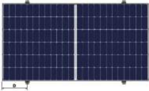
Installation eines gerahmten Moduls mit Befestigungen an den Längsseiten Balken senkrecht zu den Längsseiten (Klemmlänge \geq 50 mm)
